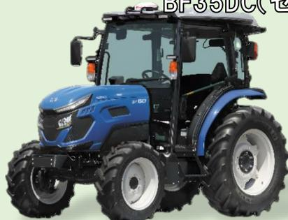
有人搭乗型ロボットトラクタ
